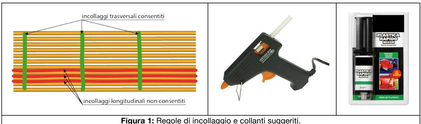
Figura 1: Regole di incollaggio e collanti suggeriti.
